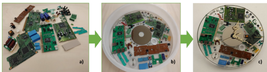
Obr. 4 Proces výroby hodin z upcyklovatelných materiálů (a) upcyklovatelný materiál; b) design ve formě; c) finální výrobek)
