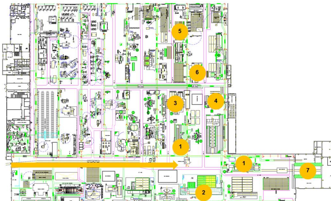
Obrázek 12: Sled technologických operací - současný stav
